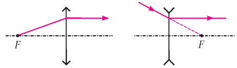
Собирающая линза Рассеивающая линза
